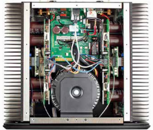
De 4B3 is een dual mono ontwerp met twee (gestapelde) dikke ringkerntrafos en maar liefst 8 dikke (5600uF) bufferelco's per kanaal.
