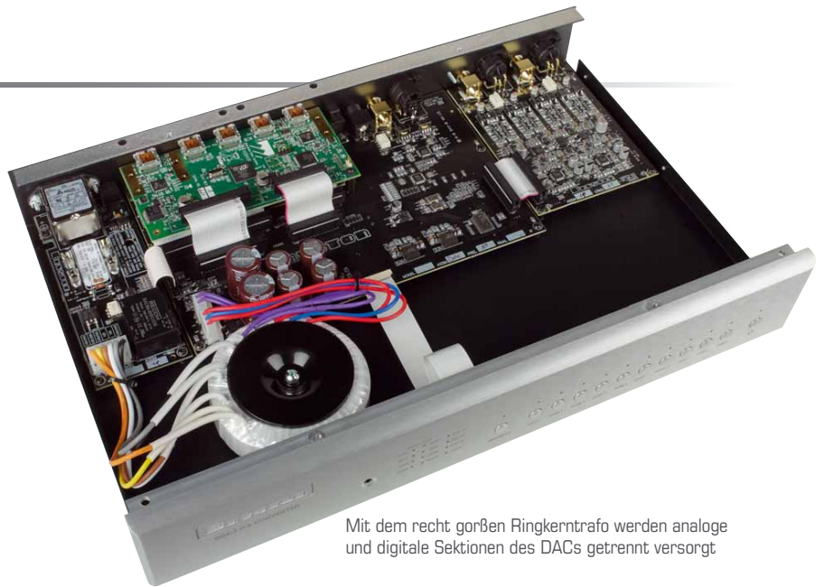
Zwei Quarze kümmern sich um das richtige Timing der Signale. Einer pro Frequenzvielfaches
