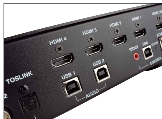
Die HDMI-Eingänge verarbeiten leider keine Dolby-Kodierungen, sondern nur PCM und DSD
