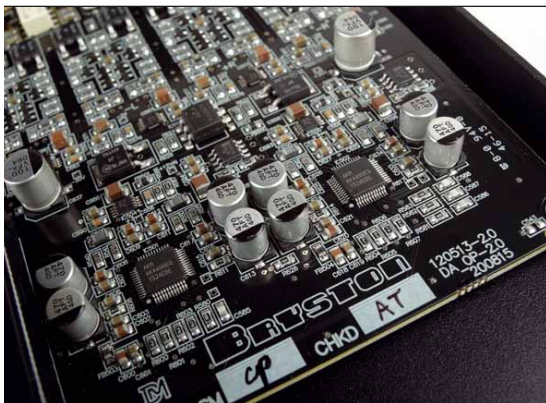
Die beiden AKM-DAC-Chips sitzen direkt vor der analogen Ausgangsstufe, um die Signalwege kurz zu halten
