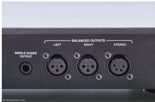
*Links die 6,3-Millimeter-Klinkenbuchse zum Anschluss unsymmetrischer Kopfhörer. Symmetrische können über die vierpolige Stereo- oder die kanalgetrennten dreipoligen XLR-Buchsen verbunden werden*
