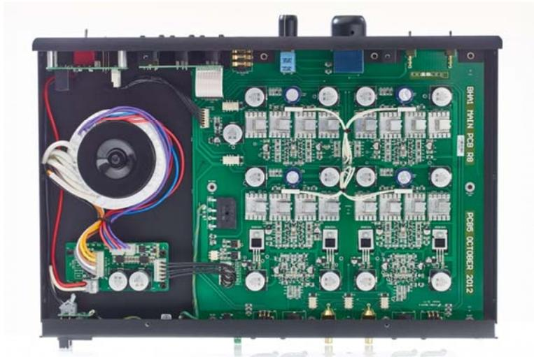
*Der Briston ist größtenteils in SMD-Technik diskret aufgebaut*
