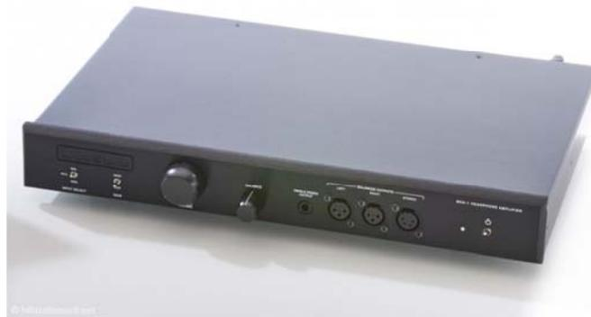
*Zum Test kam der BHA-1 in der Heimversion mit einer Breite von 43 Zentimetern. Er ist auch in einer Profivariante mit 48 Zentimetern für den Rack-Einbau zum selben Preis lieferbar*
