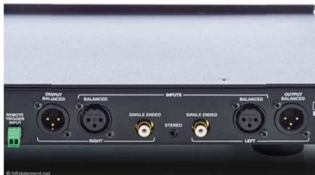
*Das Anschlussfeld des Bryston: An den symmetrischen Ausgängen liegt ein in der Lautstärke und Balance geregeltes Signal an.*
